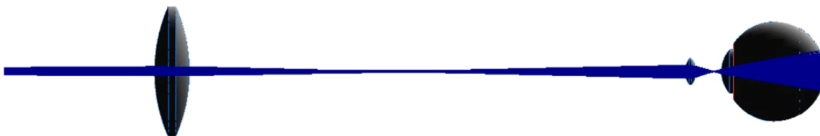
Bild 2c: Mikroskop mit objektivseitig auftreffendem divergentem Laserstrahl
