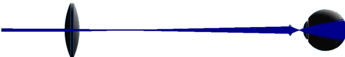
Bild 2d: Mikroskop mit objektivseitig auftreffendem konvergentem Laserstrahl
